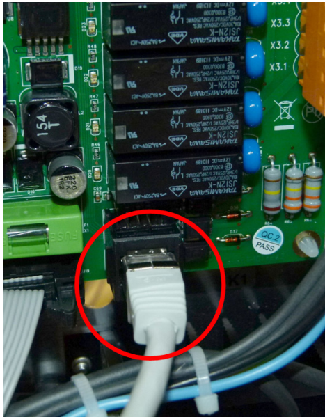
Figure 1 - Connecteur bus série RS 485 à l'alimentation électrique
